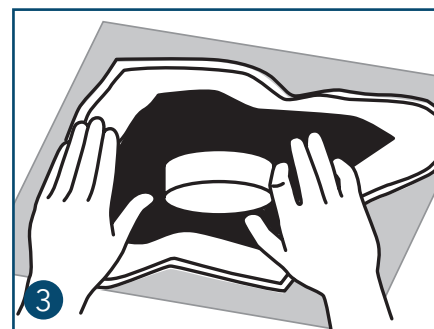
3 Før kraven over røret så tæt på dampspærren som muligt, før aftrækspapiret fjernes.
