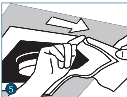
5 Kraven presses i en glidende bevægelse helt tæt på folien.
