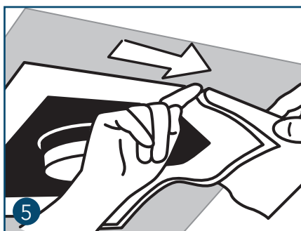
Kraven presses i en glidende bevægelse helt tæt på folien.
