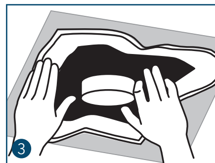
Før kraven over røret så tæt på damspærren som muligt, før aftrækspapiret fjernes.
