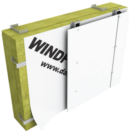
DAFA WindFoil 95 som vindspærre i ventileret ydervægsbeklædning
