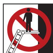
Scharnierleitern dürfen nicht als lehnende Leitern benutzt werden, ohne vollständig geöffnet und verriegelt zu werden.
