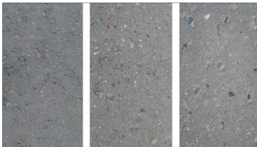
Ved afsyring af sten fjernes lidt af cementpastaen, så tilslaget bliver mere synligt, svarende til det slid der kommer i løbet af ca. ét år. Til venstre ses en ny sten, i midten en afsyret sten og til højre en ca. 1 år gammel sten.
